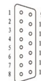
图 2.2 TCP-100、TCP-240 控制电源模块的 D15 外控通讯接口排列图
